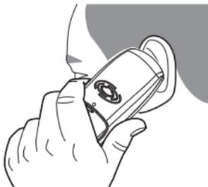
O telefone está equipado com uma antena integrada. Para conseguir uma melhor recepção, evite tapar a parte superior do telefone com a mão.
