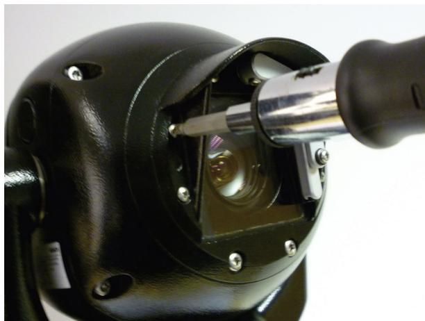
Figura 5.6 Remova os parafusos
