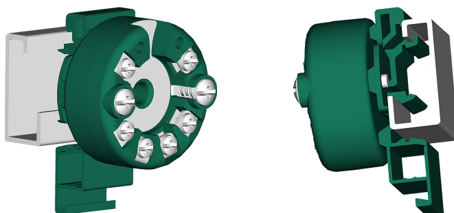
Imagem 4-2 Fixação do transmissor em calhas em G
