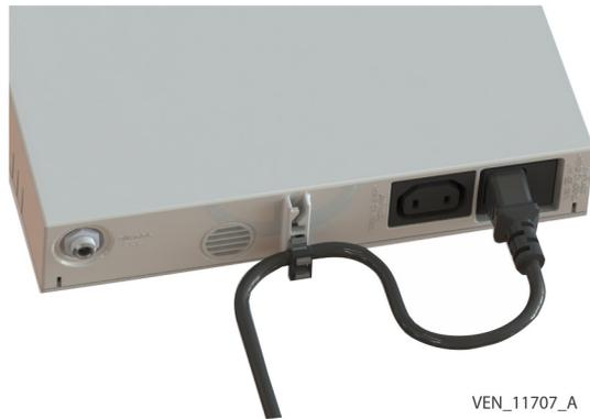
2. Ligue a outra extremidade do cabo de alimentação CA a uma tomada de alimentação eléctrica.
