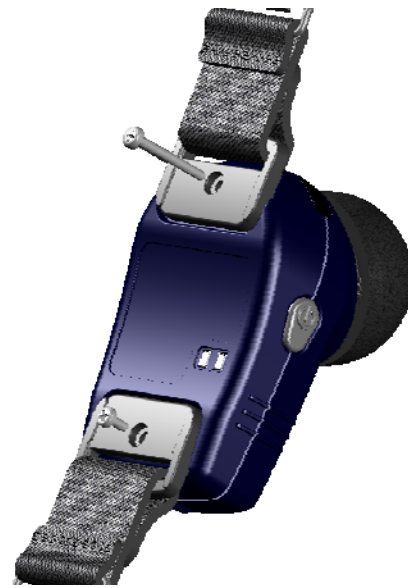
Orientação Correcta do Parafuso
