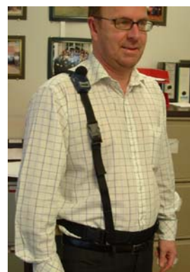
Kit de montagem em arneses CEL-6353, instalado no arnês D8147
