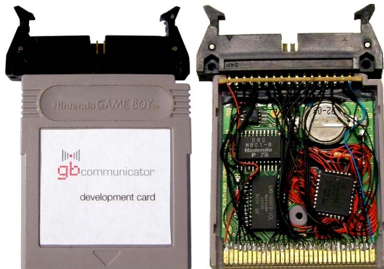
Figura 25: Cartucho de desenvolvimento
