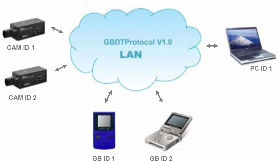
Figura 1: Arquitectura do Sistema
