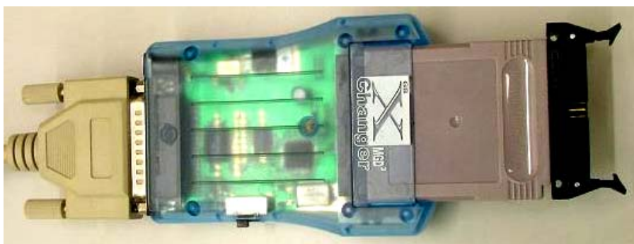
Figura 26: X-CHANGER, programador de cartuchos
