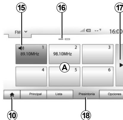
Los nombres de las emisoras de radio, cuya frecuencia no utiliza el sistema RDS, no aparecen en la pantalla. Solo su frecuencia está indicada y clasificada al final de la lista.
