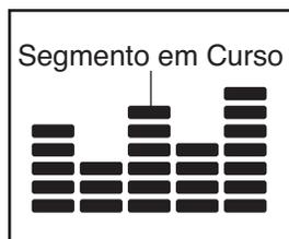
ouvir-se-á uma série de sons e o segmento seguinte do perfil começará a piscar. Se estiver programada uma configuração de velocidade ou inclinação diferente para o segmento seguinte, a configuração de velocidade ou inclinação piscará no ecrã para o alertar. O tapete rolante ajustar-se-á então automaticamente para a definição de velocidade e inclinação para o segmento seguinte.
