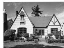
Quando a saída da cabeça de impressão estiver bloqueada, a amostra impressa assemelha-se a isto.
