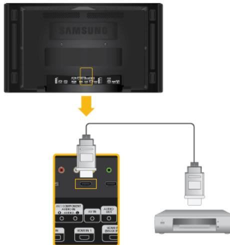
1. Ligue um cabo HDMI a *[HDMI IN 2 (MAGICINFO)]* (apenas com um modelo 460UT-2, 460UT-B ) ou *[HDMI IN 1]* no produto e à porta de saída HDMI de um dispositivo digital.
