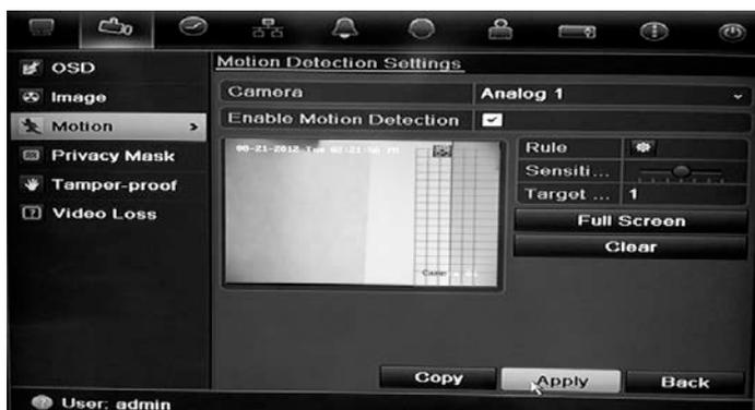
2. Seleccione a câmara analógica para detectar movimento. Cada câmara deve ser configurada individualmente.
