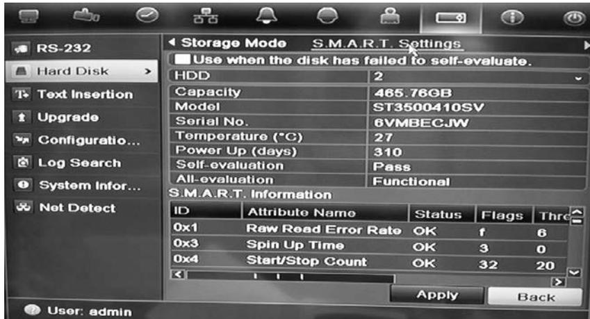
4. Se pretende continuar a utilizar um disco rígido quando o teste S.M.A.R.T. falha, seleccione a caixa **Use when the disk has failed to self-evaluate** (Utilize após falha de auto-avaliação do disco). Clique em **Aplicar** para guardar as definições.
