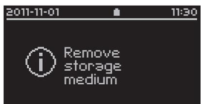
**❗ Nota:** não é necessário retirar o dispositivo de armazenamento para continuar. Contudo, a remoção é recomendada, sobretudo quando o Pima Analyser está a funcionar com a bateria integrada.
