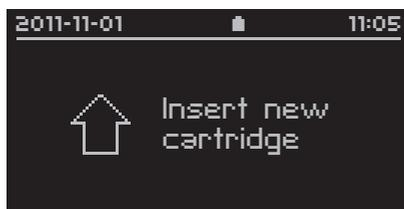
No caso de nenhum cartucho ser inserido no espaço de 30 segundos, a porta da ranhura do cartucho fecha-se automaticamente e o visor volta à janela «Run test».
