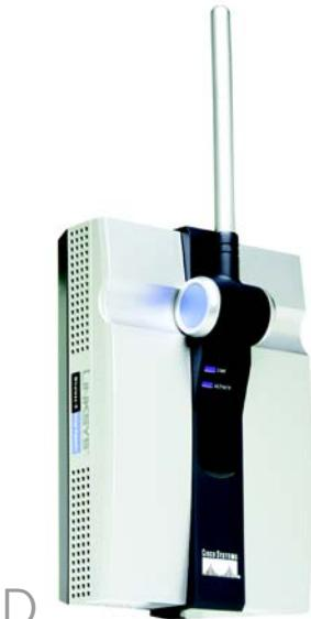
**WICHTIG:** Wenn Sie den Reichweiten-Expander mit dem Schalter für die automatische Konfiguration im Netzwerk installieren und Wireless-Sicherheit für das gesamte Netzwerk aktivieren möchten, müssen Sie diese im webbasierten Dienstprogramm aktivieren. (Weitere Informationen hierzu finden Sie im Benutzerhandbuch auf der CD-ROM. Sie können zur Konfiguration der Einheit auch den Setup-Assistenten verwenden.)
