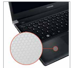
Estrutura alveolar interna
