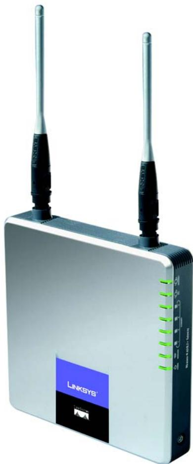
O Gateway ADSL2+ sem fios N da Linksys é a solução integrada de ligação à Internet. A função do Modem ADSL2+ é fornecer uma ligação à Internet muito mais rápida do que por acesso telefónico e sem ocupar a linha telefónica. A função de Router permite partilhar a ligação à Internet de alta velocidade com todos os computadores na casa.
