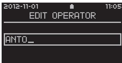
Prima  de novo para guardar o operador alterado. Se selecionar «Cancel» e confirmar com  a «Operator List» é reaberta inalterada.
