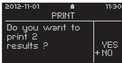
O progresso da impressão é indicado por uma barra de progresso. O relatório «Pima Test Report» contém todas as informações apresentadas nas quatro janelas de resultados do Pima Analyser. Após uma impressão bem sucedida, o visor volta automaticamente à janela «Results».
