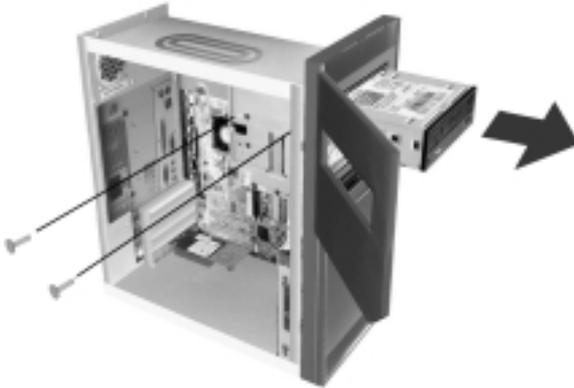
4. Faça deslizar a unidade de CD-ROM na direcção do painel anterior através da abertura, retirando-a.
