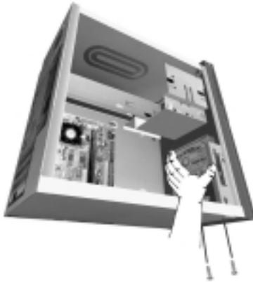
3. Empurre o tabuleiro de montagem na direcção do painel anterior e retire-o.
