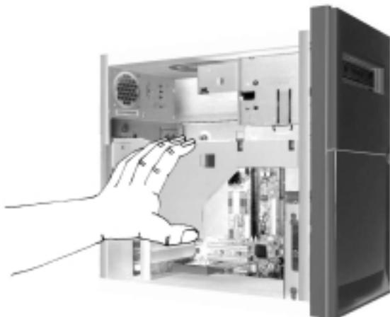
3. Desligue os cabos de alimentação e de sinal da parte posterior da unidade de disquetes.
