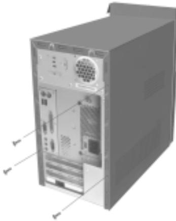
2. Segure a cobertura superior da unidade de sistema de ambos os lados e empurre-a na direcção do painel posterior do computador, cerca de 25 mm (1 pol.). Levante a cobertura superior do computador, retirando-a completamente.
