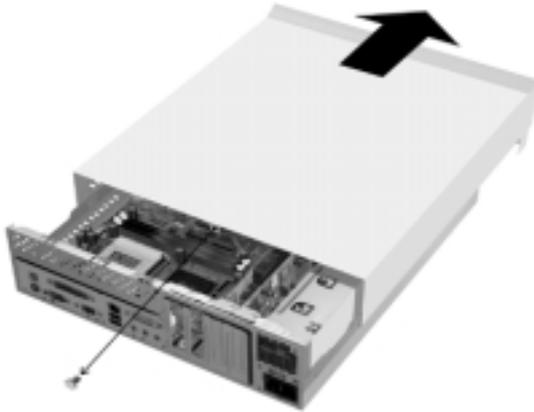
2. Segure a cobertura superior da unidade de sistema de ambos os lados e empurre-a na direcção do painel anterior do computador, retirando-a cerca de 1 cm. Levante a cobertura superior do computador, retirando-a completamente.
