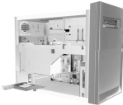
3. Se a placa tiver cabos, ligue o cabo, ou cabos, da placa adaptadora ao conector correcto da placa de sistema ou da unidade de CD-ROM.
