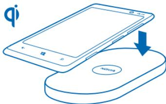
Necessita de uma tampa de carregamento sem fios da Nokia, com o logótipo Qi no interior da tampa, para o carregamento sem fios funcionar. A tampa pode vir incluída na caixa do produto ou ser vendida separadamente. Utilize apenas tampas de carregamento sem fios da Nokia originais.
