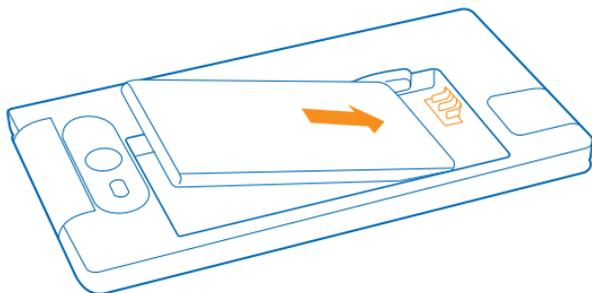
7. Prima a extremidade inferior da tampa posterior contra a extremidade inferior do telemóvel.
