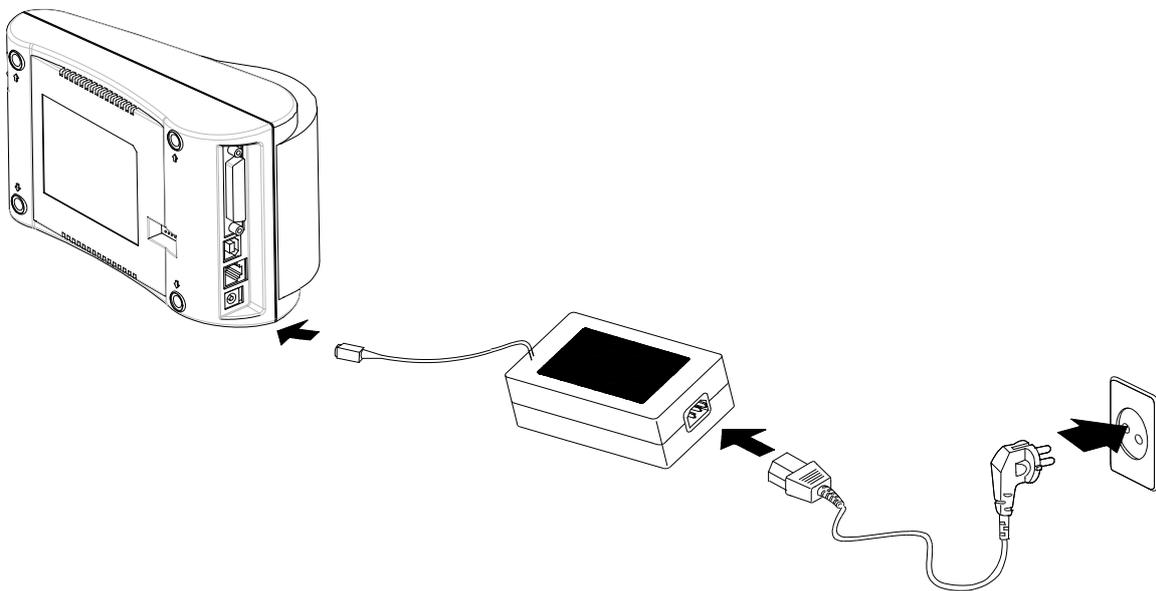
2-1-4 Conecte o cabo de alimentação do adaptador AD ao terminal de alimentação da impressora.
