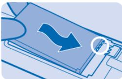
5. Coloque novamente a tampa posterior e pressione-a para baixo até esta encaixar na posição correcta.
