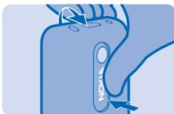
2. Se a bateria estiver inserida no telemóvel, levante-a.
