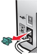
**Nota:** Depois de removida esta ficha, o equipamento específico da região ou do país que for ligado à impressora através do adaptador, conforme mostrado, não funcionará correctamente.
