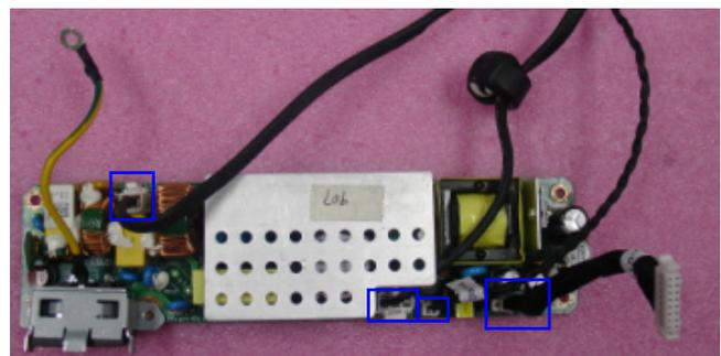
4. Disassemble LVPS Module.
