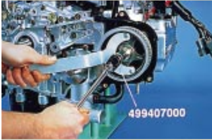
Reinstalling Camshaft Sprockets
