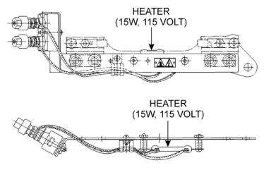
HEATER FOR CIRCUIT CONTROLLER COMPARTMENT
