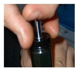
13) Screw it using the Bitubo tool code 00214
