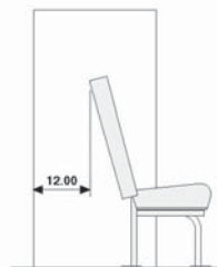
SIDE EMERGENCY DOOR CLEAR AISLE
