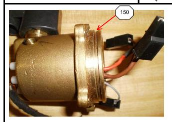
**150)** CAREFULLY REMOVE THE ORIGINAL O-RING FROM THE FUEL PUMP HOUSING AND DISCARD
