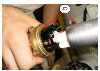
270) POSITON FUEL PUMP TO LINE UP BELOW THE FUEL PUMP **HOUSING AS SHOWN**
