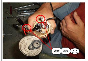
250) LOCATE AND GRASP BROWN WIRE WITH FEMALE CONNECTOR ATTACHED TO THE FUEL PUMP HOUSING; LOCATE AND GRASP BLACK WIRE WITH SPADE CONNECTOR ATTACHED TO THE FUEL PUMP
