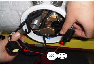
370) LOCATE AND GRASP THE FUEL SUPPLY / COMMUTATOR
