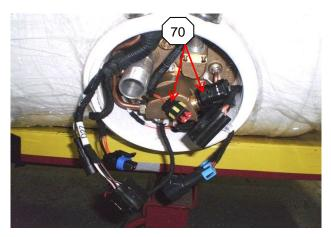
70) LOCATE AND GRASP THE ELECTROVALVE SUPPLY SOLENOID WIRE HARNESS LEAD (RED & BROWN WIRES); CAREFULLY DISCONNECT THE CONNECTOR FROM THE SOLENOID
