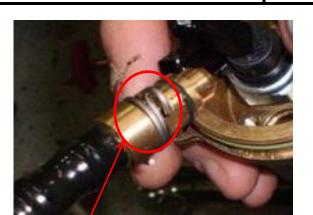
210) POSITION FUEL PUMP TO HOUSING; LOCATE MOUNTING CLIP ATTACHED TO FUEL PUMP SUPPLY HOSE FITTING
