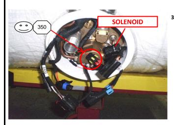
350) LOCATE AND GRASP THE ELECTROVALVE SUPPLY SOLENOID
