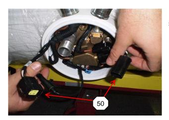
**50)** LOCATE AND GRASP THE FUEL SUPPLY / COMMUTATOR WIRE HARNESS LEADS; CAREFULLY DISCONNECT THE CONNECTORS
