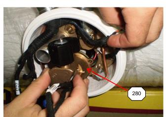
**320)** TORQUE SCREWS DIAMETRICALLY TO 5.5 Nm +/- .50
