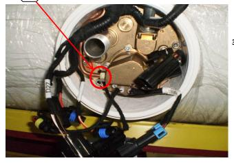
**340)** LOCATE FUEL PUMP RETURN LINE; HANDSTART FITTING ON LINE INTO HOUSING; USING AN 8mm WRENCH, FULLY TIGHTEN THE FITTING INTO THE HOUSING
