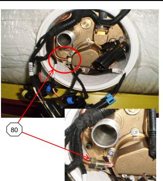
**80)** LOCATE FUEL SUPPLY LINE ATTACHED TO THE FUEL PUMP HOUSING; USING A 13mm WRENCH, CAREFULLY LOOSEN THE FITTING AND REMOVE THE LINE FROM THE HOUSING
