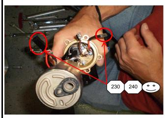
230) LOCATE AND GRASP RED WIRE WITH SPADE CONNECTOR ATTACHED TO THE FUEL PUMP HOUSING: LOCATE AND GRASP RED WIRE WITH BLACK FEMALE CONNECTOR ATTACHED TO FUEL PUMP
