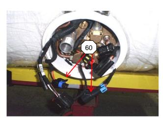
**60)** LOCATE AND GRASP THE LPG FUEL PUMP WIRE HARNESS LEADS (RED & BLACK WIRES); CAREFULLY DISCONNECT THE CONNECTORS
