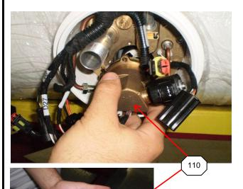
110) CAREFULLY REMOVE THE FUEL PUMP HOUSING AND FUEL PUMP ASSEMBLY FROM THE MULTIVALVE
