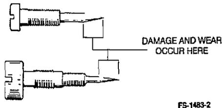
FIGURE 6-11. MIXTURE NEEDLE INSPECTION
