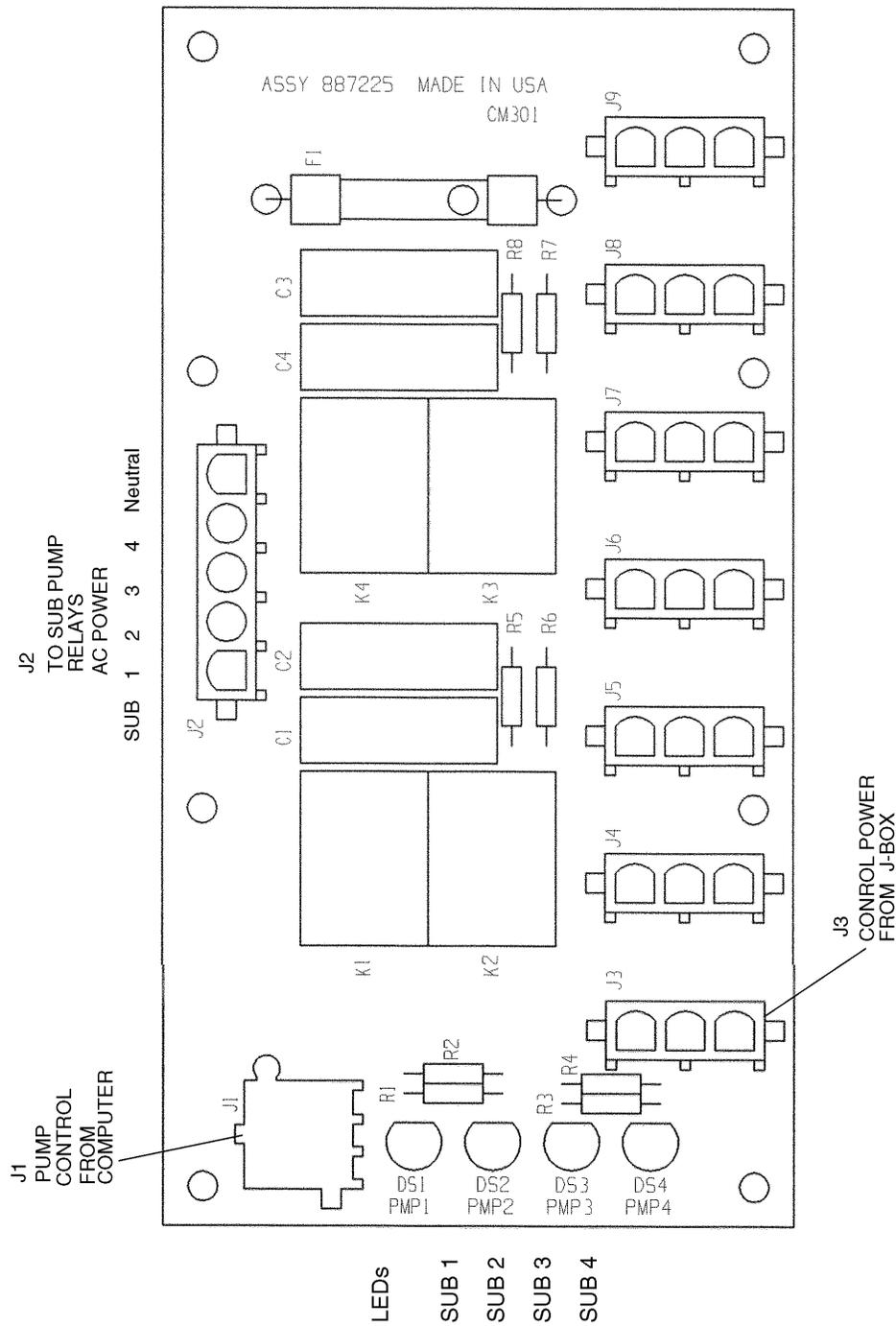
FIGURE 3-3. RELAY BOARD.
