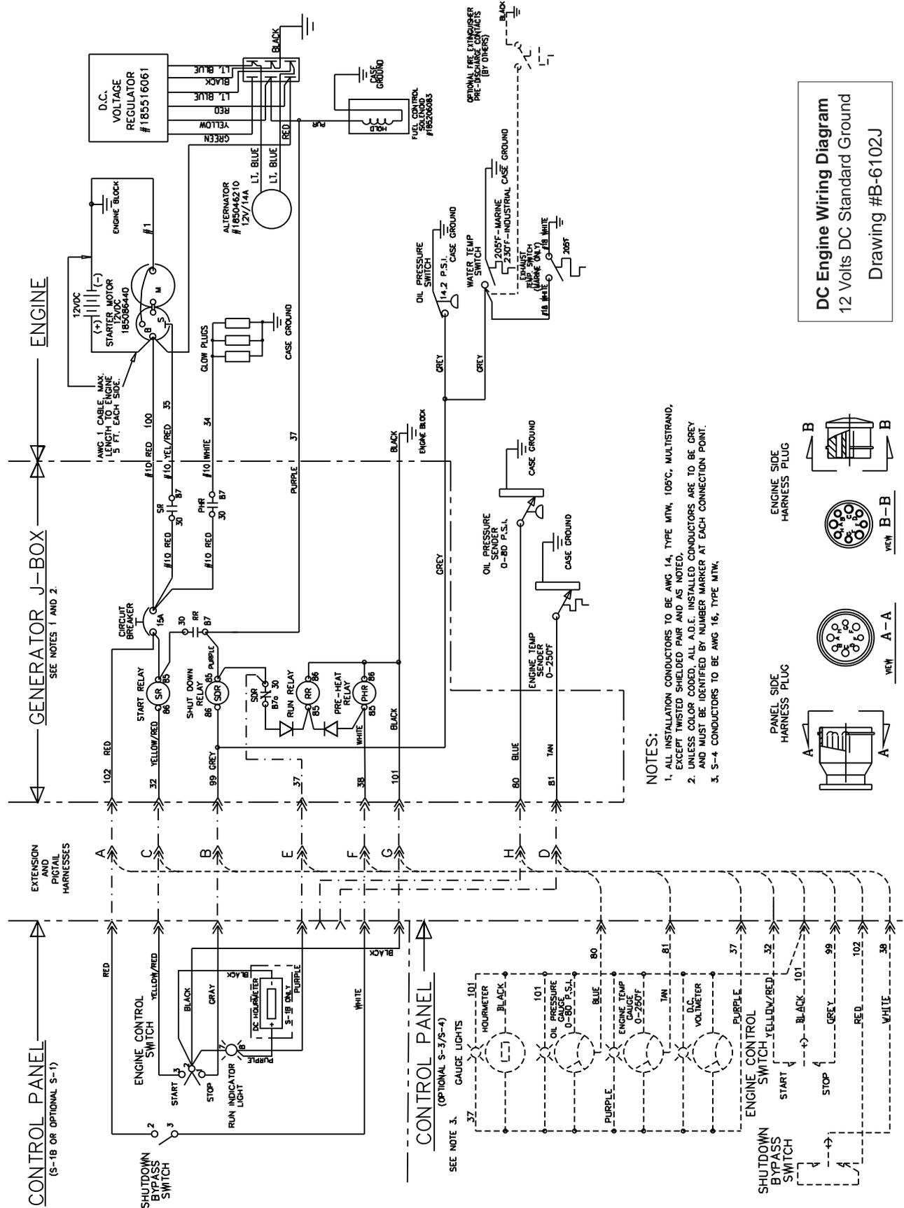
**DC Engine Wiring Diagram**
