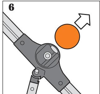
Deslice ambos extremos de la capota en los puntos de pivotaje, hasta que queden bien encajadas en posición (**Figura 6a**).
