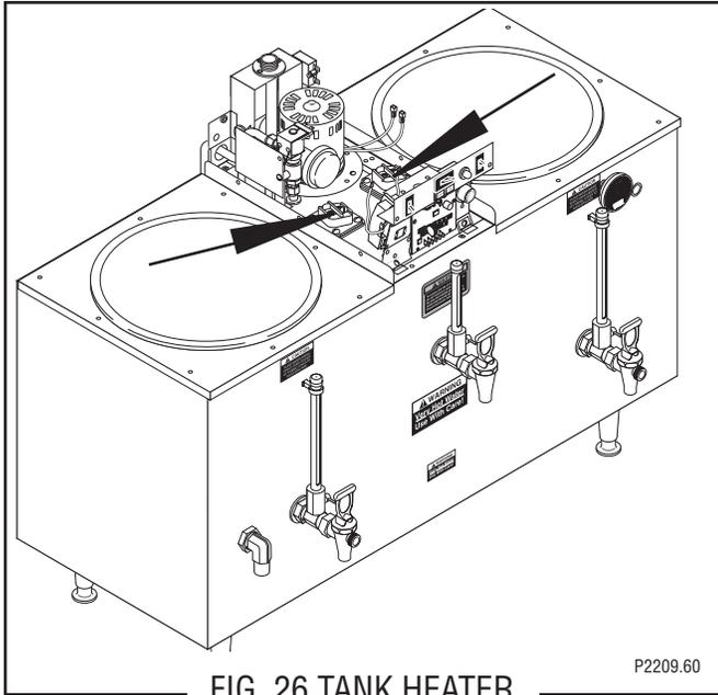
FIG. 26 TANK HEATER
