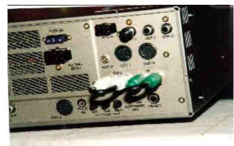
Diese muß man für den normalen KW-Betrieb nur außen mit Cinch-Cinch-Koaxkabeln brücken. Da es sich um Kurzwelle (d. h. f < 30 MHz) handelt, dürfte die auftretende Dämpfung vernachlässigbar sein.
