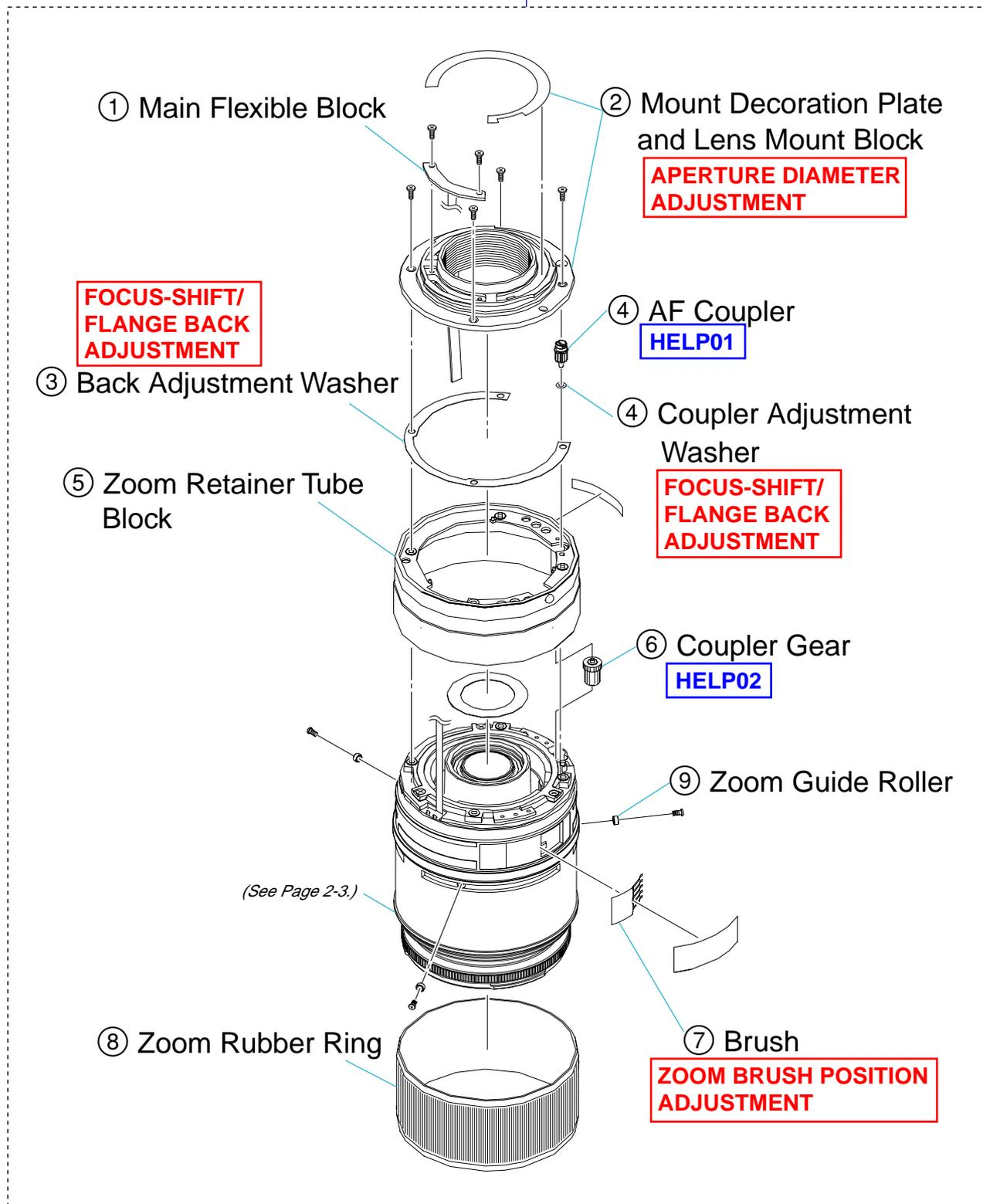
2-1-2. GEAR BARREL, ZOOM CAM BARREL AND ZOOM CONTROL TUBE BLOCK
