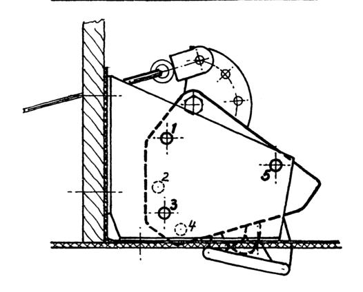
Kupplung mit den Bohrungen Nr. 1, 3 und 5 am Beschlag befestigen.
