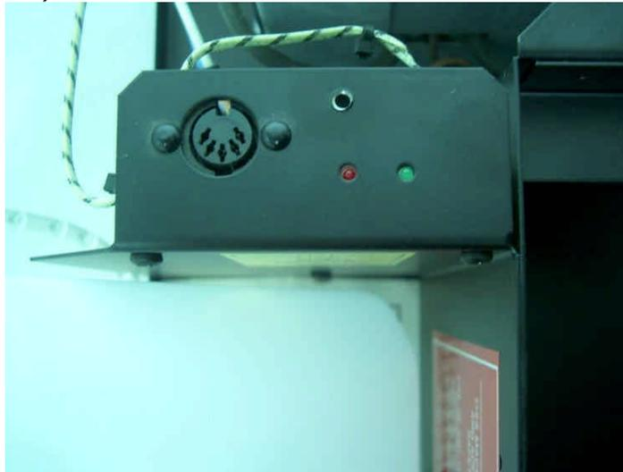
8. **IF YOU PRESS THE RAMP BUTTON IN THE LED SHOULD GO OUT AND COME BACK ON AGAIN WHEN YOU RELEASE THE BUTTON.**
