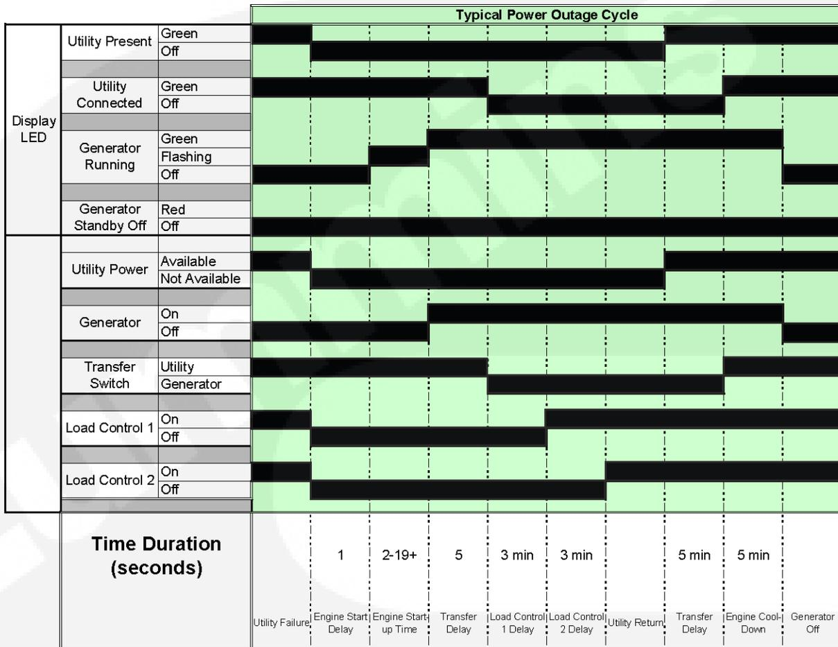
**FIGURE 4. TYPICAL POWER OUTAGE CYCLE TIMING DIAGRAM**
