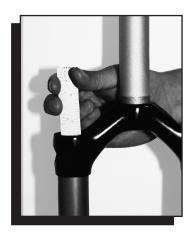
Checking Oil Level Kontrolle des Ölstandes Verificación del nivel de aceite Vérification du niveau d'huile Controllo del livello dell'olio Oliepeil controleren Verificação do nível de óleo オイル量のチェック
