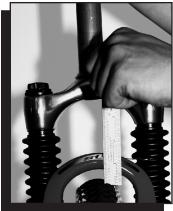
Tire Clearance Reifenabstand Espacio libre de <sup>'</sup>la cubierta Distance arceau/pneu Spazio libero del pneumatico Bandspelina Folga do pneu タイヤクリアランス
