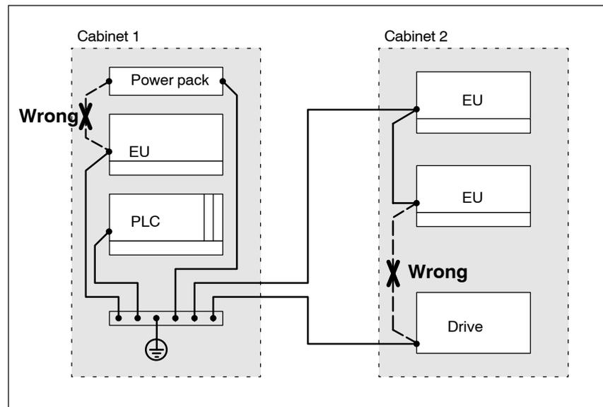
Figure 3-47 Equipotential bonding
