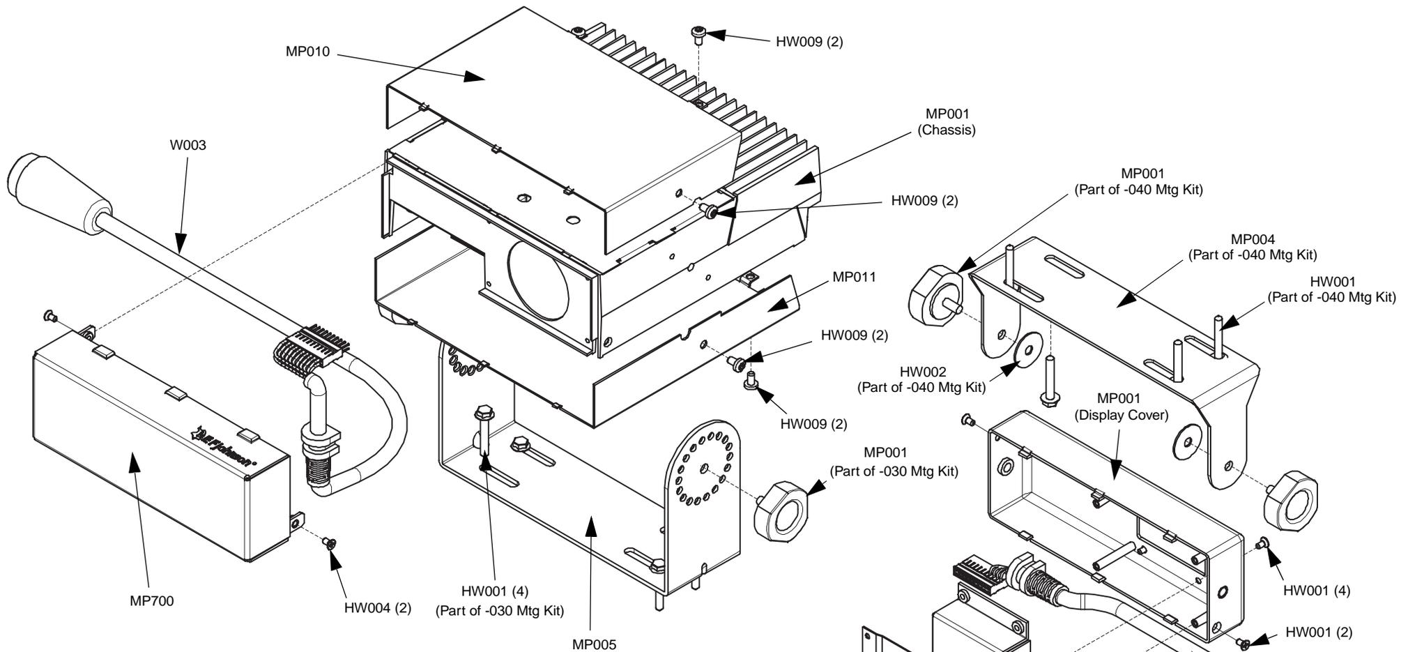
**REMOTE TRANSCEIVER MECHANICAL PARTS**
