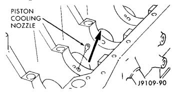
Fig. 13 Piston Cooling Nozzles
