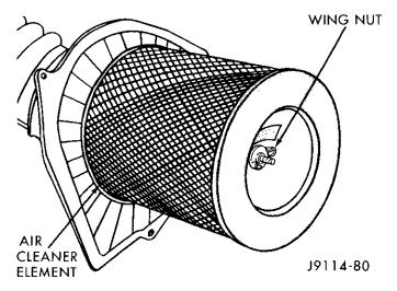
Fig. 2 Air Filter Element
