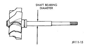
Fig. 18 Shaft Bearing Diameter
