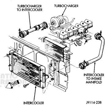
Fig. 3 Diesel Inter-Cooler
