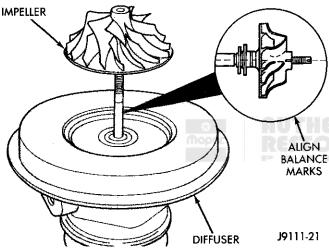
Fig. 24 Align Balance Marks-Impeller
