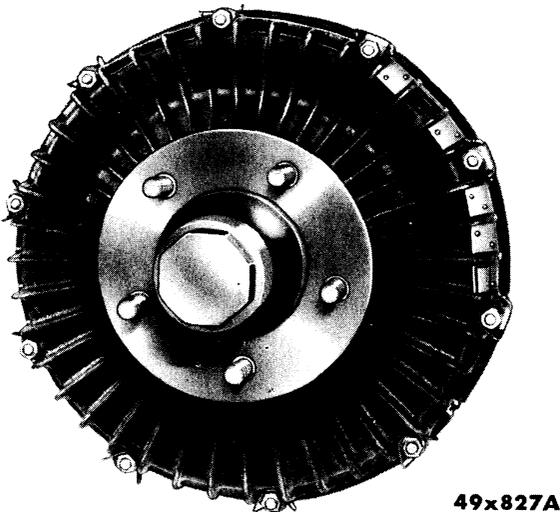
Fig. 43—Front Disc Brake
