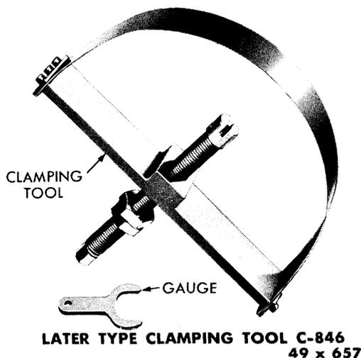
Fig. 30—Clamping Tool C-846
