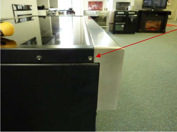
REMOVE 2X SCREWS AS SHOWN FROM THE EDGE OF THE HOT-PLATE
