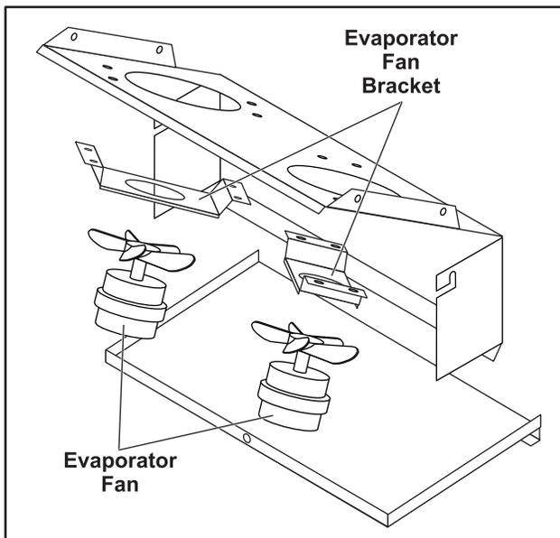
**Figure 13. Evaporator Fans**
