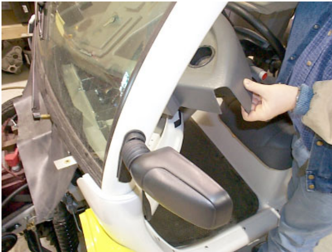
Fig. # 5 Remove upper dash
