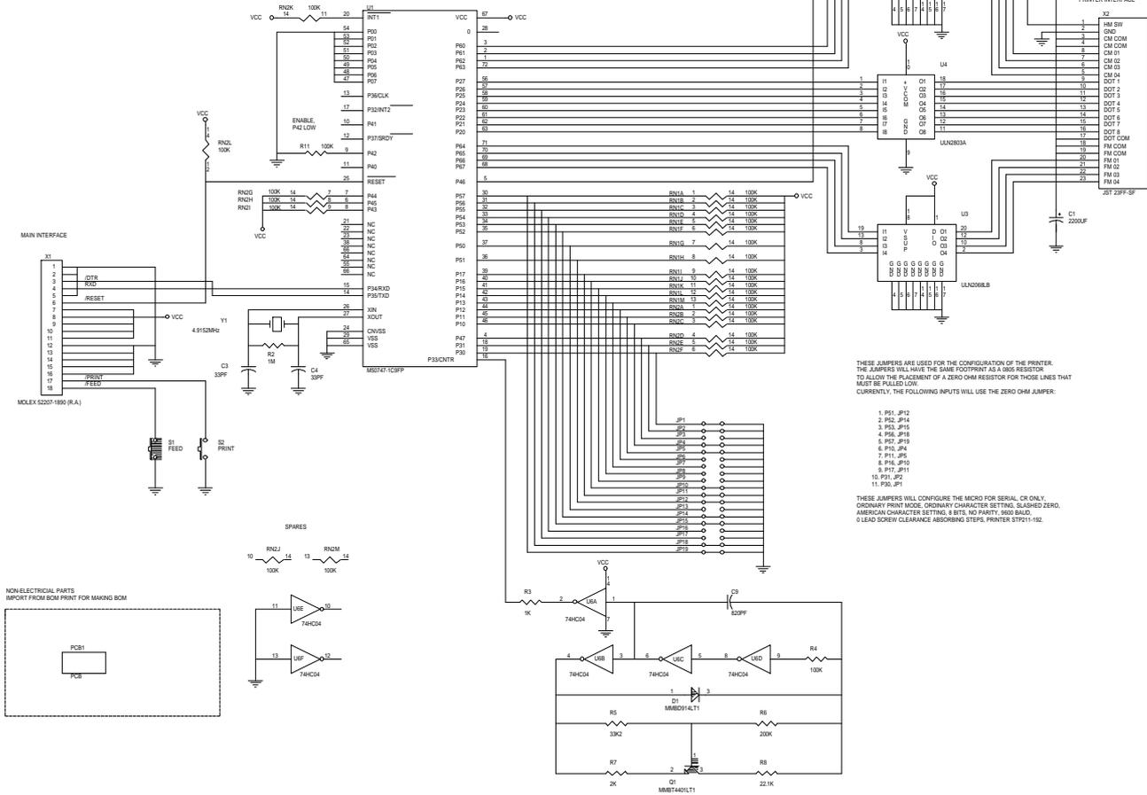
THESE JUMPERS ARE USED FOR THE CONFIGURATION OF THE PRINTER. THE JUMPERS WILL HAVE THE SAME FOOTPRINT AS A 980S RESISTOR.
