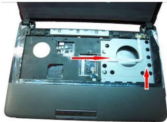
1.1.15 Disassemble USB module.
