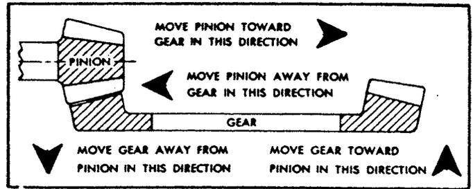
ALL CONTACT BEARINGS SHOWN BELOW ARE ON LEFT HAND SPIRAL RING GEAR — THE DRIVE IS ON THE CONVEX SIDE OF THE TOOTH.
