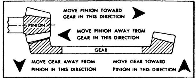
ALL CONTACT BEARINGS SHOWN BELOW ARE ON RIGHT HAND SPIRAL RING GEAR — THE DRIVE IS ON THE CONVEX SIDE OF THE TOOTH.
