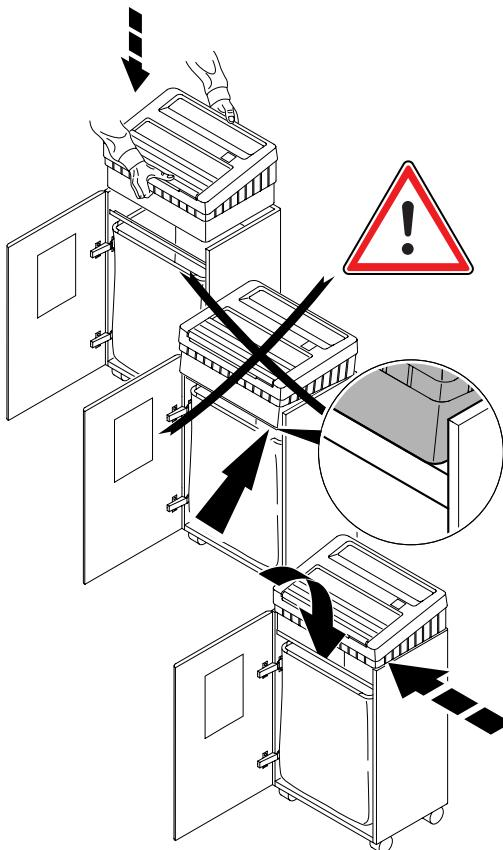
**D** Türe öffnen, Maschine mit Bedienfeld nach vorne aufsetzen! Auf Finger achten!
