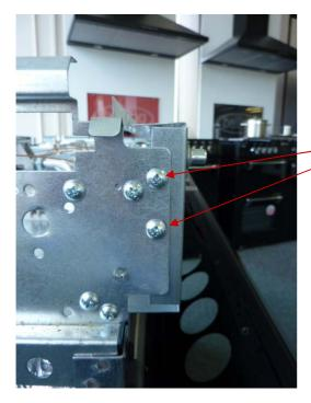
FOLLOW STEPS 3/5AND REMOVE THE HOTPLATE AND FACIA PANEL REMOVE 2 SCREWS AS SHOWN ON EITHER SIDE TO RELEASE THE INNER FACIA PANEL
