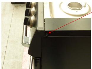
REMOVE 2X SCREWS ONE EITHER SIDE AS SHOWN
