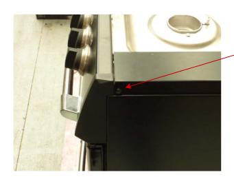
REMOVE THE 2 SCREWS (ONE EITHER SIDE) THAT SECURE THE HOTPLATE TO THE FACIA
