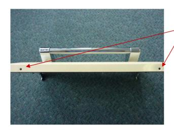
REMOVE THE 6 SCREWS AROUND THE DOOR EDGE TO SPLIT THE INNER PANEL FROM THE OUTER PANEL
